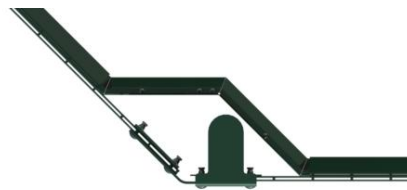
Combinatie van hoekverbinding voor binnenhoek en paaloverbrugging voor grote paaldiameters.
